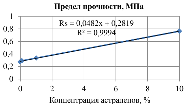
Рис. 4. Экспериментальная зависимость прочности образцов от концентрации астраленов
