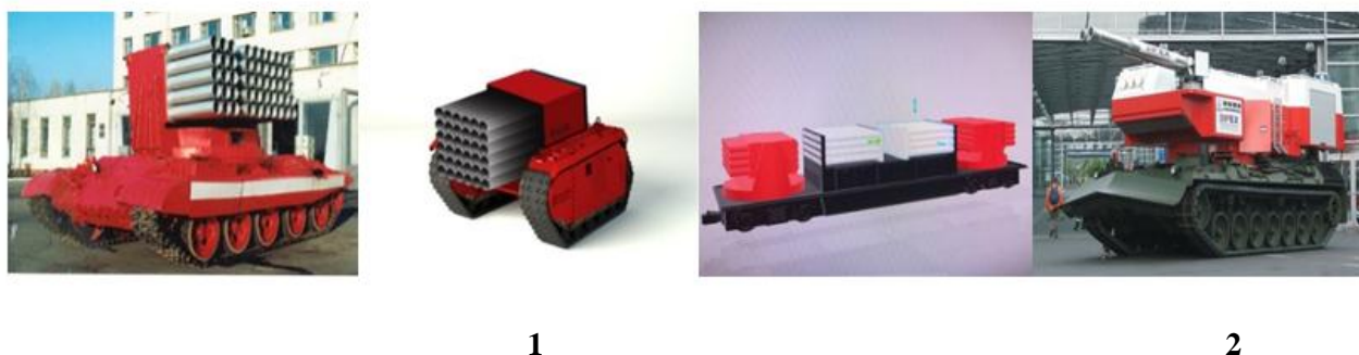
Рис. 2. 1 – ГБПМ «Импульс-3М» с башенной ММ-50, эскизы ММ на роботе и железнодорожной платформе; 2 – Немецкая пневмоимпульсная ММ-2 на шасси танка «Леопард-1» содержит также 10-тонную цистерну с водой, компрессор высокого давления
